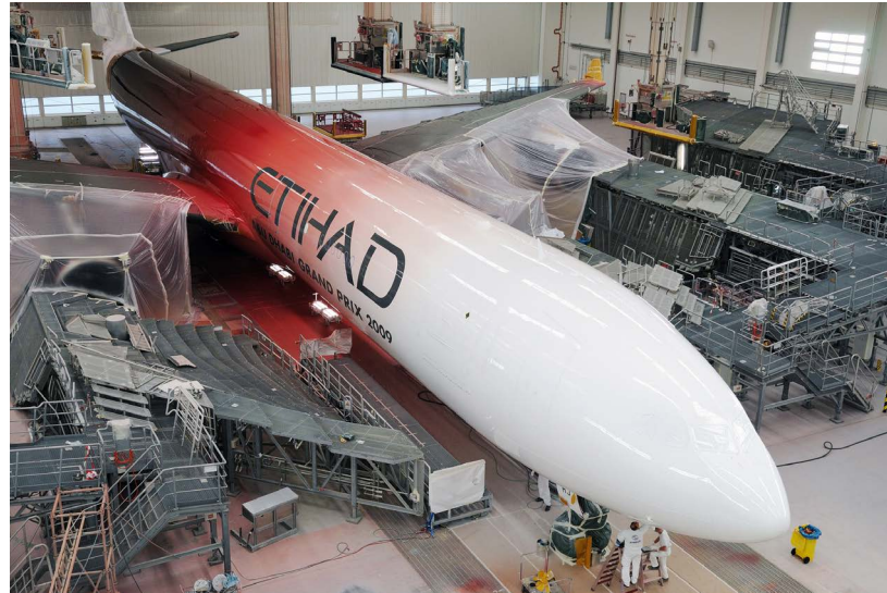
Verlaufslackierung auf A 340 bei Airbus | Hamburg zur Eröffnung des Formel 1 Grand Prix in Abu Dhabi
